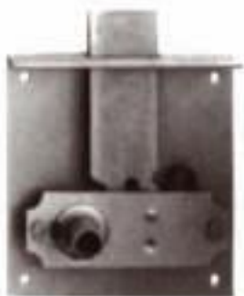
PO267 Serrure de tiroir Palâtre Fer ou laiton Axes 20 à 90 par 5 mm et 100 mm Livree sans clé
